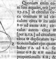
jungantur Kr, Ka. erit igitur ut ra ad EZ ita B O ad KH, & ita KH ad HA. quoniam igitur ut Г A ad EZ ita B e ad KH, erit triangulum BEZ triangulo Kra æquale. & quoniam ut FA ad EZ ita eft KH ad HA; ut autem KH ad H A ita K Γ Δ triangulum ad triangulum A Γ Δ; erit igitur ut Γ Δ ad EZ ita triangulum K Γ Δ, hoc est BEZ, ad triangulum AΓΔ: ergo ut AΓΔ triangulum ad triangulum BEZ ita basis EZ ad TA balim. triangula igitur expolita suis basibus reciproce funt proportionalia.
