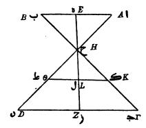
rallelogrammo AB duo sunt parallelogramma AEHD, HGBZ, et spatium DZ = EG et linea AH ducta in directum producitur in punctum B cadit.
