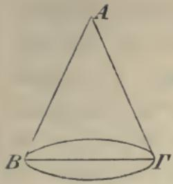
nam quoniam linea ab *A* ad *B* ducta communis est sectio plani secantis et superficie conicae, recta est *AB*. et eadem de causa *AG*. uerum etiam *BG* recta est. itaque *ABG* triangulus est.
