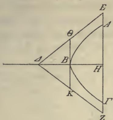
itaque recta in  $B$  contingens rectae  $A\Gamma$  parallela est [prop. V—VI]. contingat igitur  $\Theta BK$ . itaque cum  $E\Delta, \Delta Z$  concurret [prop. III]. quoniam igitur  $A\Gamma$  et  $K\Theta$  parallelae sunt, et  $K\Theta$  cum  $\Delta K, \Delta \Theta$  concurrit, etiam  $A\Gamma$  cum  $\Delta E, \Delta Z$  concurret.
