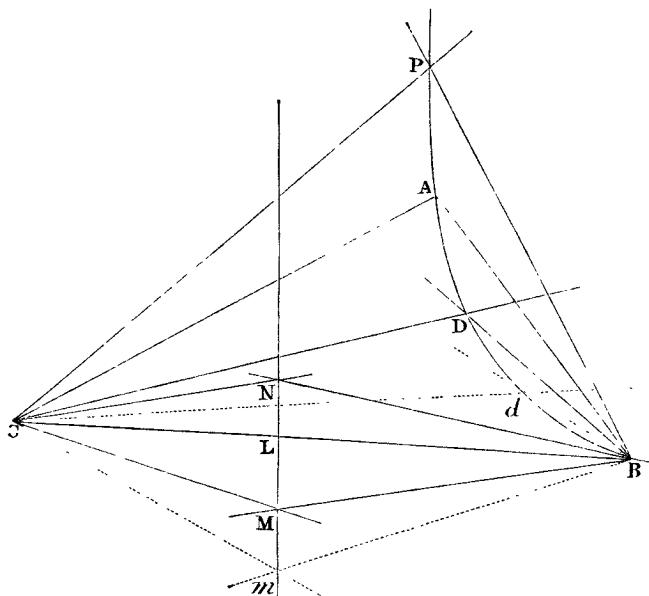
per puncta  $B, C$  transeuntem; & ubi punctum  $m$  accedit ad puncta  $L, M, N$ , punctum  $d$  (per constructionem) accedet ad puncta  $ADP$ . Describetur itaque sectio conica transiens per puncta quinque  $A, B, C, P, D$ . Q. E. F.
