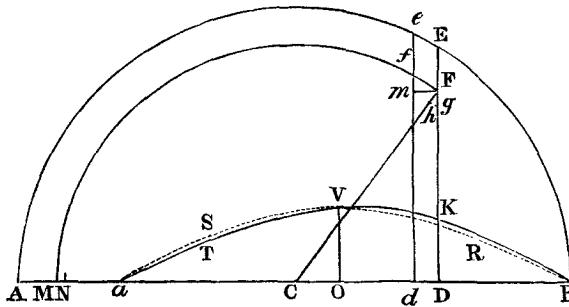
Et area illa, si maneat longitudo  $a B$ , augetur vel diminuetur in ratione ordinatim applicatarum  $DK$ ; hoc est, in ratione resistantiae, ideoque est ut longitudo  $a B$  & resistantia conjunctim. Proindeque rectangulum sub  $A a$  &  $\frac{1}{2} a B$  est ut  $a B$  & resistantia conjunctim, & propterea  $A a$  ut resistantia. *Q. E. D.*
