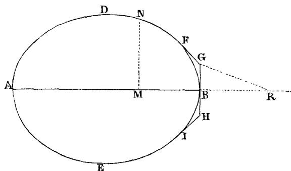
Quod si figura  $DNFG$  ejusmodi sit curva, ut si ab ejus punto quovis  $N$  ad axem  $AB$  demittatur perpendicularum  $NM$ , & a punto dato  $G$  ducatur recta  $GR$  quæ parallela sit rectæ figuram tangentи in  $N$ , & axem productum secet in  $R$ , fuerit  $MN$  ad  $GR$  ut  $GR$   $cub.$  ad  $4BR \times GBq$ ; solidum quod figuræ hujus revolutione circa axem  $AB$  facta describitur, in medio raro prædicto ab  $A$  ver-
