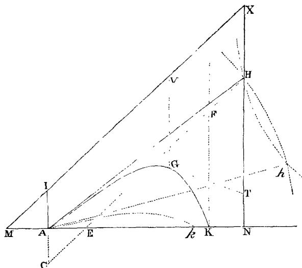
*Reg. 3.* Si tam angulus  $N A H$ , quam corporis velocitas in  $A$ , gravitasque acceleratrix servetur, & proportio resistantiæ in  $A$  ad gravitatem motricem augeatur in ratione quacunque; augebitur proportio  $A H$  ad  $A I$  in eadem ratione, manente parabolæ prædictæ latere recto, eique proportionali longitudine  $\frac{A H q}{A I}$ : & propterea
