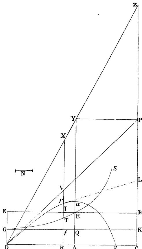
$\frac{tG T}{N}$ , vel, quod perinde est, cape  $Rr$  æqualem  $\frac{G T I E}{N}$ ; & projectile tempore  $DR TG$  perveniet ad punctum  $r$ , describens curvam lineam  $DraF$ , quam punctum  $r$  semper tangit, perveniens autem ad maximam altitudinem  $a$  in perpendiculari  $AB$ , & postea semper appropinquans ad asymptoton  $PC$ . Estque velocitas ejus in puncto quovis  $r$  ut curvæ tangens  $rL$ . *Q.E.I.*
