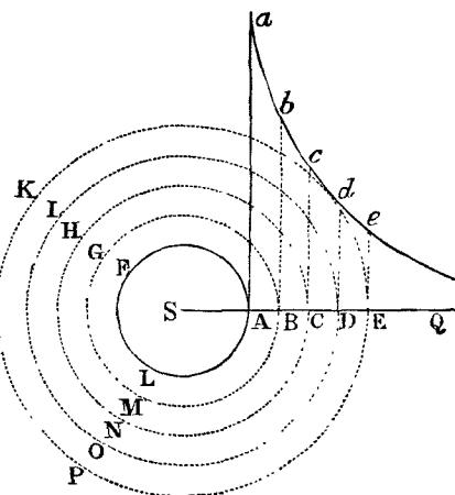
*Corol.* 2. Si fluidum in vase cylindrico longitudinis infinitæ contineatur, & cylindrum alium interiore contineat, revolvatur autem cylindrus uterque circa axem communem, sintque revolutionum tempora ut ipsorum semidiametri, & perseveret fluidi pars unaquæque in motu suo : erunt partium singularum tempora periodica ut ipsarum distantiaæ ab axe cylindrorum.
