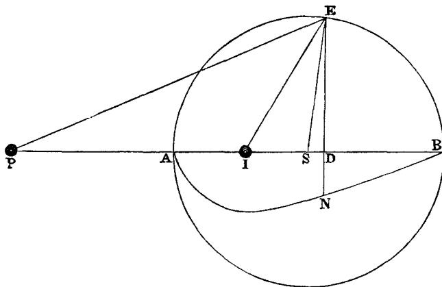
cata ratione distantiarum, attractiones in *I* & *P* erunt ad invicem ut *SP quad.* ad *SA quad.*: Si in quadruplicata, ut *SP cub.* ad *SA cub.* Unde cum attractio in *P*, in hoc ultimo casu, inventa fuit reciproce ut *PS cub.* × *PI*, attractio in *I* erit reciproce ut *SA cub.* × *PI*, id est (ob datum *SA cub.*) reciproce ut *PI*. Et similis est progressus in infinitum. Theorema vero sic demonstratur.
