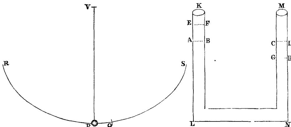
in crure *KL* ascendet ad altitudinem *EF*, descenderit aqua in crure *MN* ad altitudinem *GH*. Sit autem *P* corpus pendulum, *VP* filum, *V* punctum suspensionis, *RPQS* cyclois quam pendulum describat, *P* ejus punctum infimum, *PQ* arcus altitudini *AE* æqualis.
