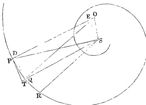
Ad  $OP$  demittantur perpendicularia  $QD$ ,  $SE$ , & linearum rationes ultimæ erunt hujusmodi:  $TQ$  ad  $PD$  ut  $TS$  vel  $PS$  ad  $PE$ , seu  $2PO$  ad  $2PS$ ; item  $PD$  ad  $PQ$  ut  $PQ$  ad  $2PO$ ; & ex æquo perturbate  $TQ$  ad  $PQ$  ut  $PQ$  ad  $2PS$ . Unde fit  $PQ$  æquale  $TQ \times 2PS$ . *Q. E. D.*
