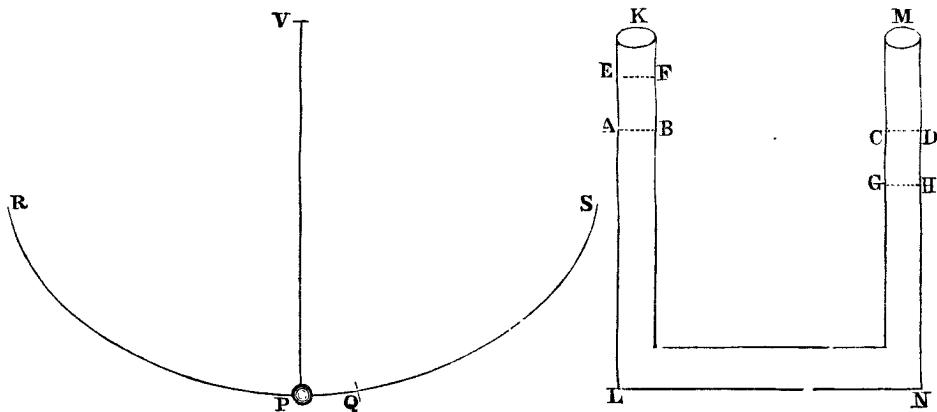
*PR.* Vis etiam, qua pondus  $P$  in loco quovis  $Q$  acceleratur & retardatur in cycloide (per corol. prop. LI) est ad ejus pondus totum, ut ejus distantia  $PQ$  a loco infimo  $P$  ad cycloidis longitudinem  $PR$ . Quare aquæ & penduli, æqualia spatia  $AE$ ,  $PQ$  describentium, vires motrices sunt ut pondera movenda ; ideoque, si aqua & pendulum in principio quiescunt, vires illæ movebunt eadem æqualiter temporibus æqualibus, efficientque ut motu reciproco simul eant & redeant. *Q.E.D.*
